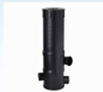
Hvirvelfilter til nedgravning og indendørs montage. Kan leveres i 3 størrelser WF110 afvand.areal 200m 2 WF160 afvand.areal 500m 2 WF315 afvand.areal 3000m 2
